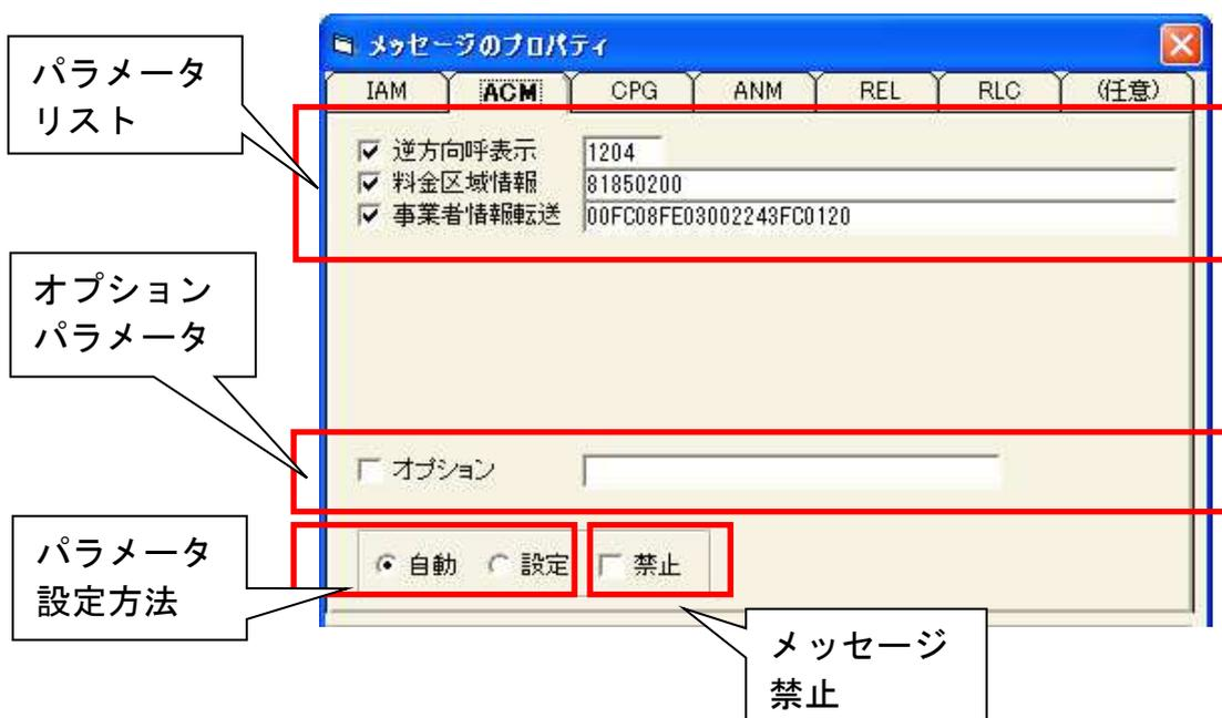
編集可能なパラメータリストおよびメッセージ末尾に付加できるオプションパラメータ設定、パラメータの設定方法選択、メッセージ送出許可／禁止選択の各部から構成されます。
