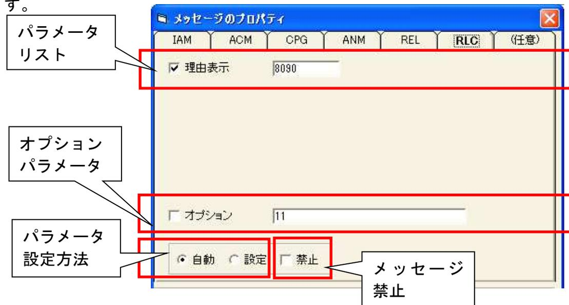
編集可能なパラメータリストおよびメッセージ末尾に付加できるオプションパラメータ設定、パラメータの設定方法選択、メッセージ送出許可／禁止選択の各部から構成されます。
