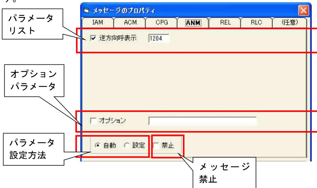
編集可能なパラメータリストおよびメッセージ末尾に付加できるオプションパラメータ設定、パラメータの設定方法選択、メッセージ送付許可／禁止選択の各部から構成されます。
