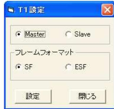
「設定」ボタンを押すと設定が反映されます。回線と同期が確立することを確認してください。
