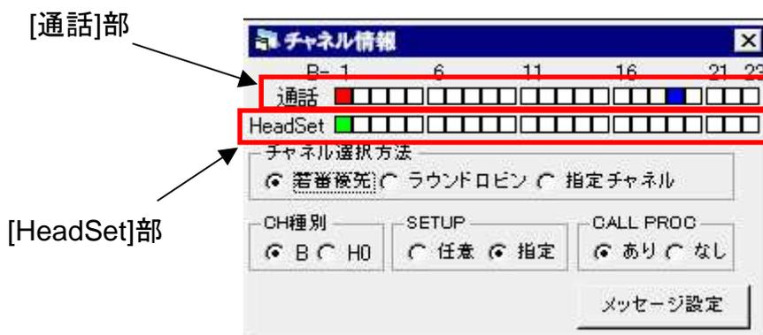
[通話]部で使用中表示の□の真下の□([HeadSet]部)を押すと、該当チャンネルのトーンが停止し、ヘッドセットで通話可能となります。(□：緑)
