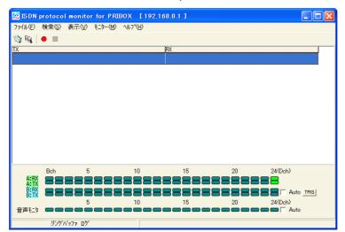
2 つのデータ採取チャネルを「A Line」「B Line」として区別し、"「A Line」で Dch データを採取、「B Line」で B1ch データを採取"のように設定します。 また、TX と RX で異なるチャネルをモニタするように設定することも可能です。
