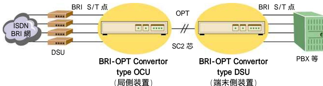
局側装置と端末側装置を 1 対向で使用します。
