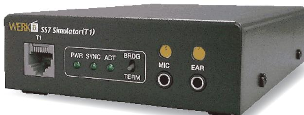
SS7 Simulator (T1)はT1回線 1回線を收容し、任意のタイムスロット上で共通線信号方式(SS7)のレベル1からレベル3までとユーザーパート部におけるISUPをエミュレートします。また、SS7のリンクはA面、B面の2リンクをサポートしています。T1のフレーム構成はESFとSF(D4フレーミング)の双方に対応しております。
